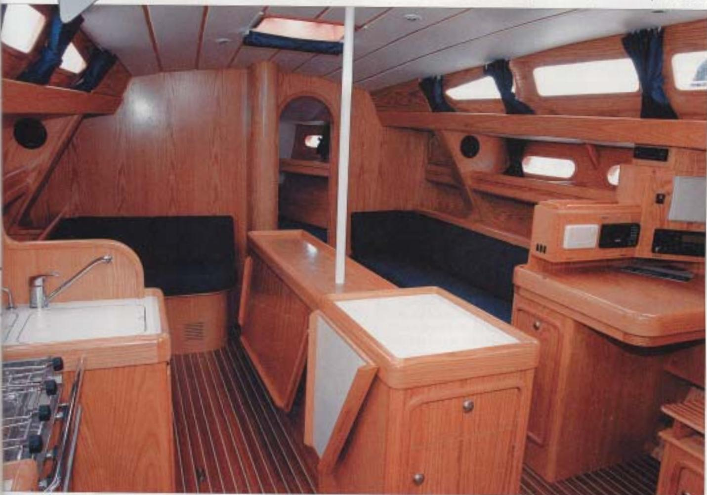
Le carré est très lumineux grâce à ses longs hublots de rouf, ses deux panneaux de pont mais aussi aux quatre hublots de coque. Sur le 395, il est possible de circuler autour du puits de dérive qui supporte la table du carré.
