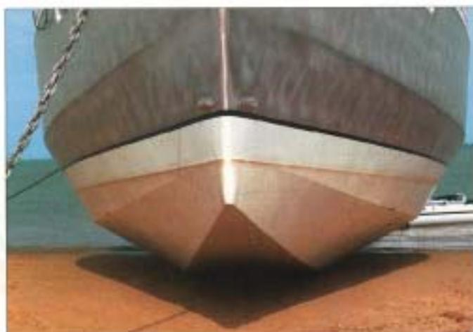
Le plat des fonds qui supporte le poids du bateau est réalisé dans une tôle d'alliage d'aluminium de 8 mm.
