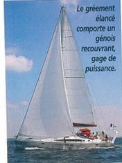
Le gréement élancé comporte un génois recouvrant, gage de puissance.
